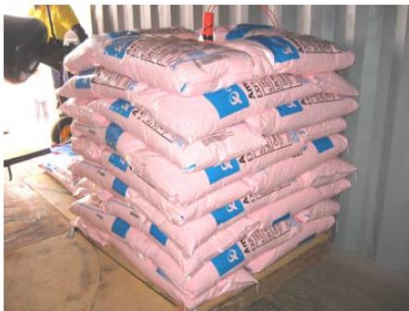
Essai ISO-2 : Disposition des sacs d'ANFO pour une palette (1 tonne de produits)
