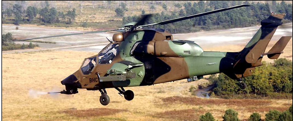
Figure 5 – Le TIGRE dans sa version (FRA) Hélicoptère d'appui-protection (HAP) en Close Combat Attack (CCA) canon.
