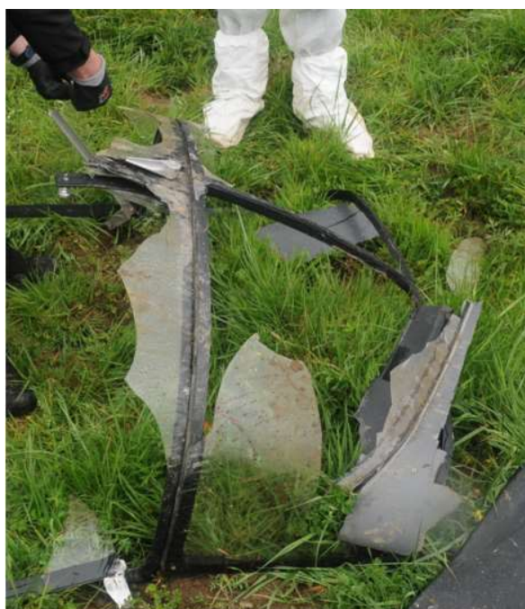
Figure 9 : montants de verrière et parebrise
