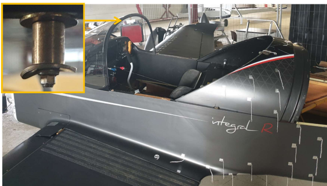
Figure 2 : déformation du téton de verrouillage
