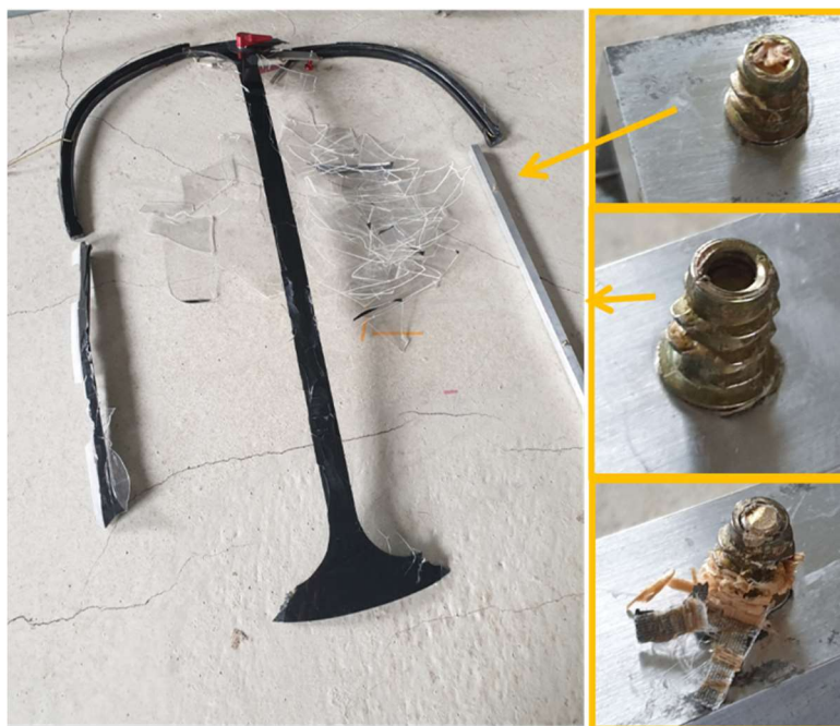
Figure 7 : débris de verrière et rail retrouvés
