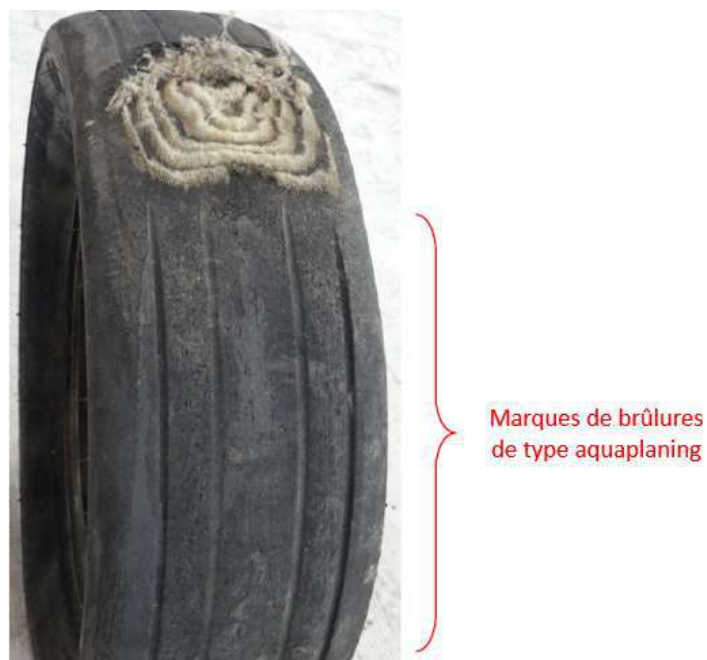
Figure 12 : escalope et marques d'aquaplaning sur le pneumatique droit
