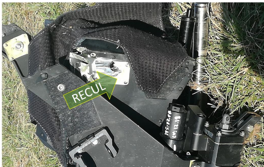
Figure 7 : endommagement du boîtier de tête
