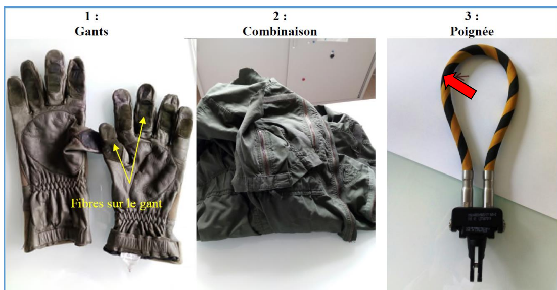
Figure 10 : localisation sur les gants des fibres similaires retrouvées à l'intérieur de la poignée d'éjection
