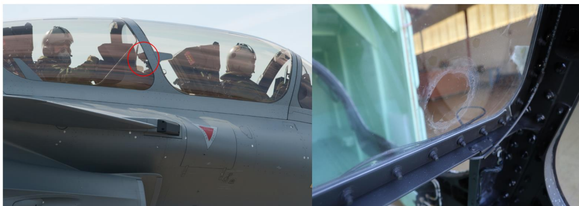
Figure 20 : emplacement de la caméra au parking et traces visibles laissées par la ventouse de fixation
