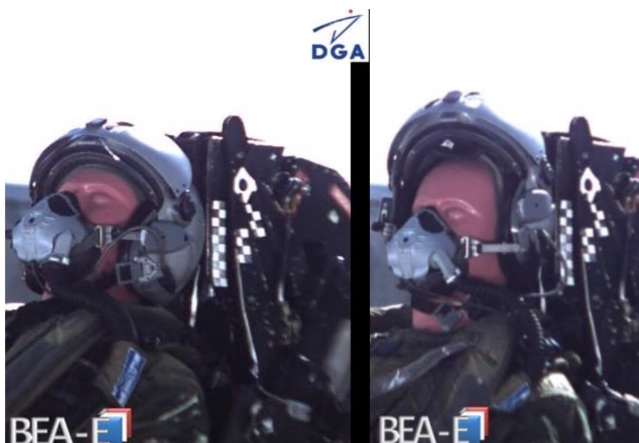
Figure 15 : positionnement du casque sur la tête du mannequin avant l'essai (gauche) et pendant l'essai (droite)
