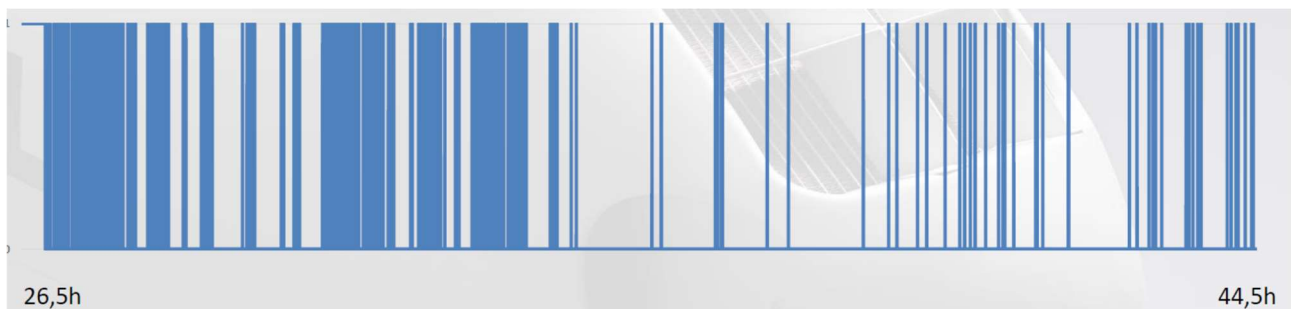
Figure 8 : séquences de réinitialisation de l'ECU (en blanc)
