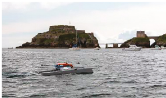
Ulysse, le catamaran électrique autonome qui construit une carte bathymétrique des fonds marins. © ENSTA Bretagne
