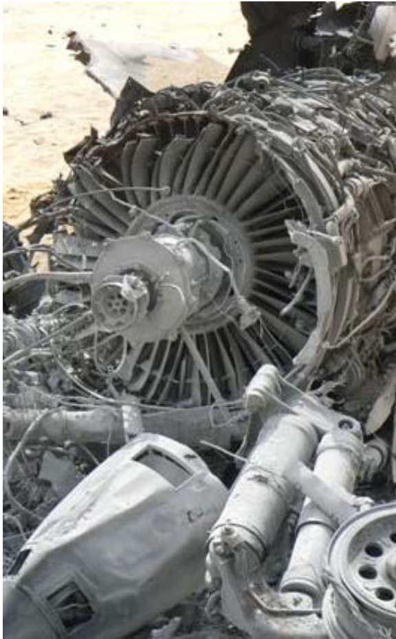
Photo n° 1 : Premier étage du compresseur
