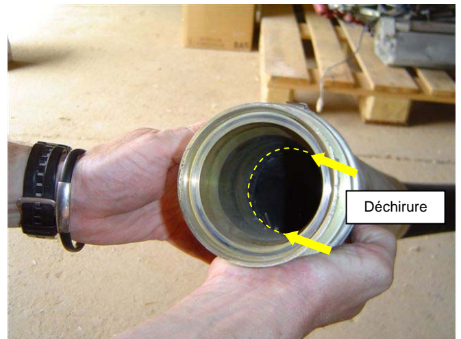
Photo n° 6 et 7 : Localisation de la déchirure du tuyau (détails)
