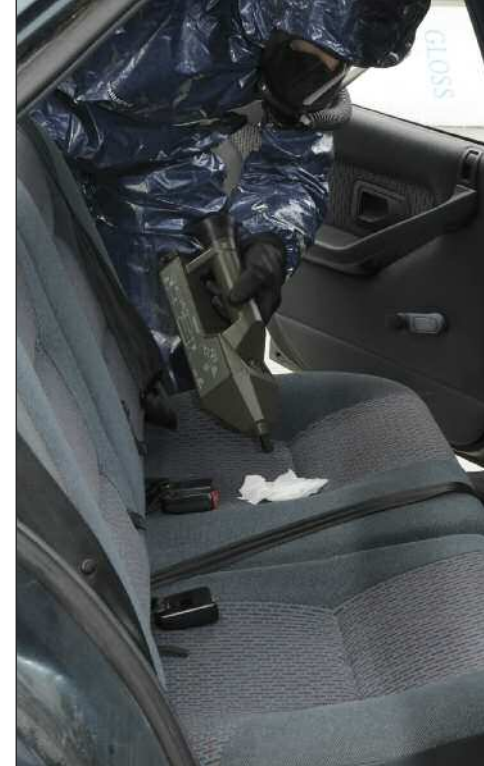
L'appareil portatif AP4C permet de déterminer le niveau de concentration dans l'atmosphère. Une valeur limite d'exposition à court terme est fixée et est à respecter afin de préserver la santé des personnes qui y sont confrontées.
